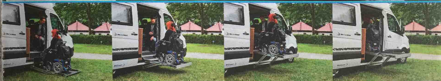
BÜHNENTALENT In weniger als einer Minute hievt der AMF-K90-Kassettenlift Sabine hinauf ins Mobil. Die Hebebühne könnte bis zu 300 Kilo tragen
